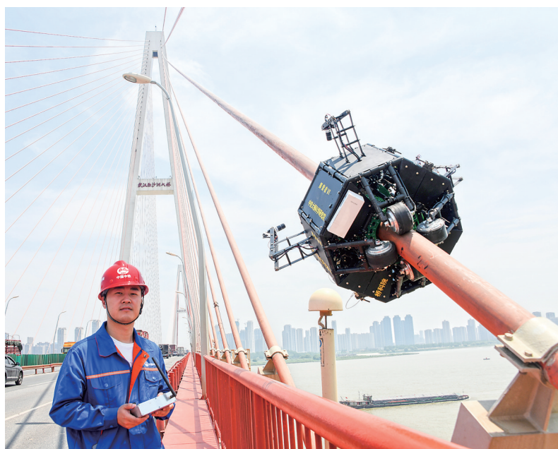
5月7日,技术人员在操控第六代“探索者”号桥梁拉索智能检测机器人。(受访者供图)
