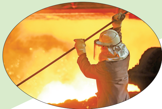
▲2021年8月19日,工人在鞍钢新4号高炉进行高炉出铁作业。 新华社记者 杨青 摄
