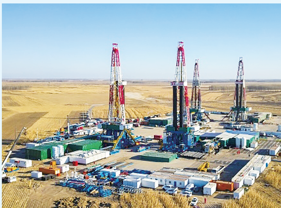
2020 年拍摄的大庆油田古页油平 1 试验区钻井现场。(资料照片 新华社发)
