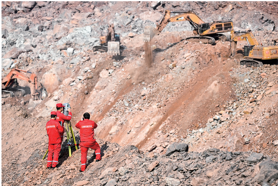
2月24日,救援人员使用边坡雷达监测事故现场。新华社记者 连振 摄
