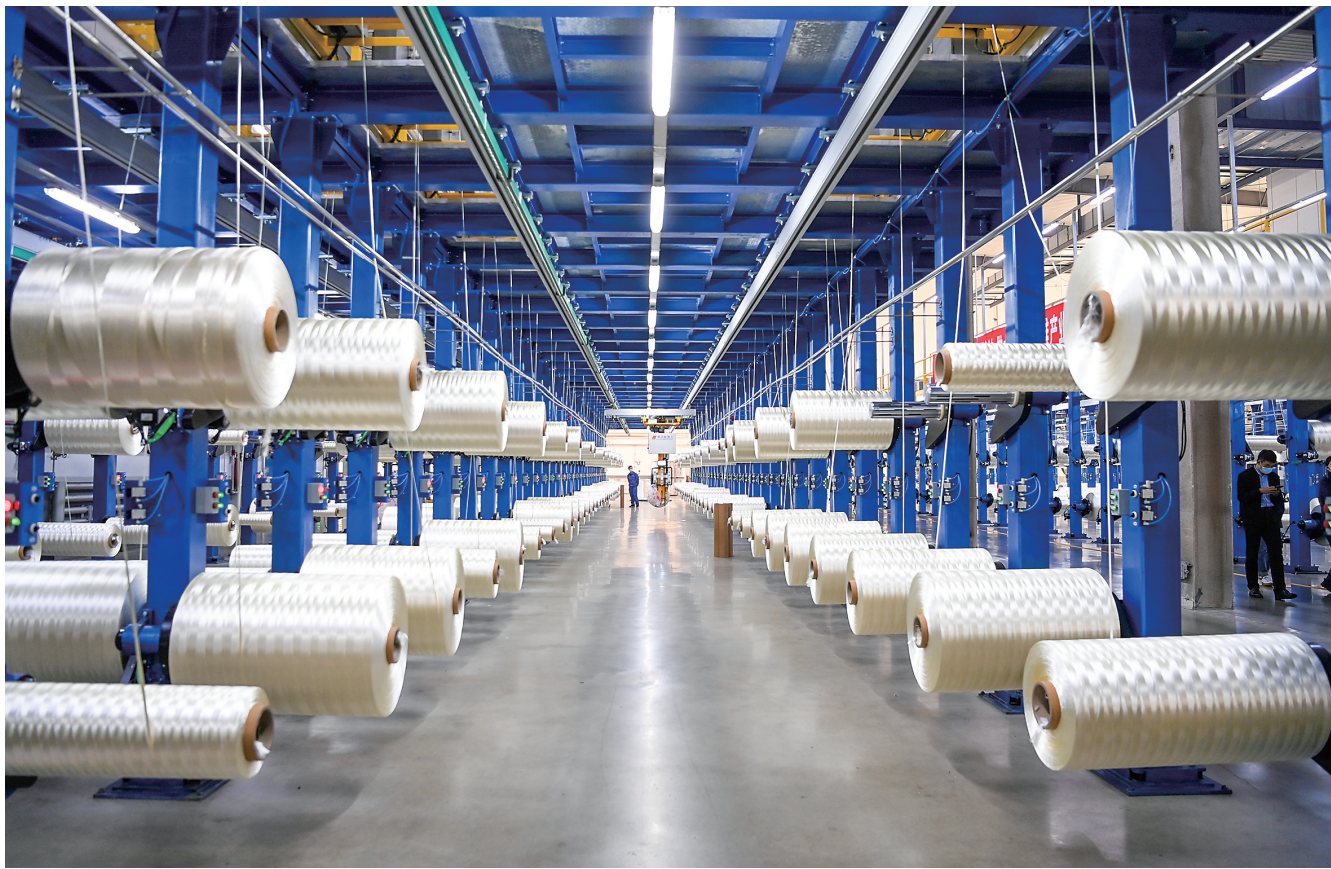
工人在吉林化纤集团国兴碳纤维公司生产车间整理碳纤维原丝(资料图片)。 新华社记者 颜麟蕴 摄
