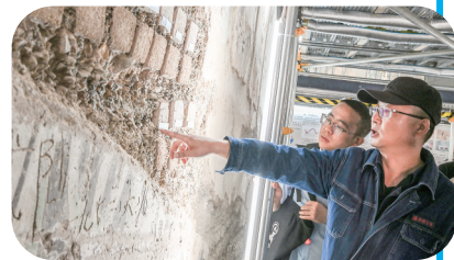
在敦煌莫高窟正在保护修缮的第55窟内,文保工作者对现场模拟试块进行对比测试(8月3日摄)。
