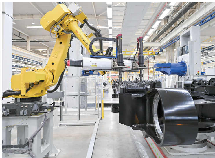
在太重集团智能高端液压挖掘机产业园区内的智能生产线上,智能装配机器人在作业。新华社记者杨晨光摄
