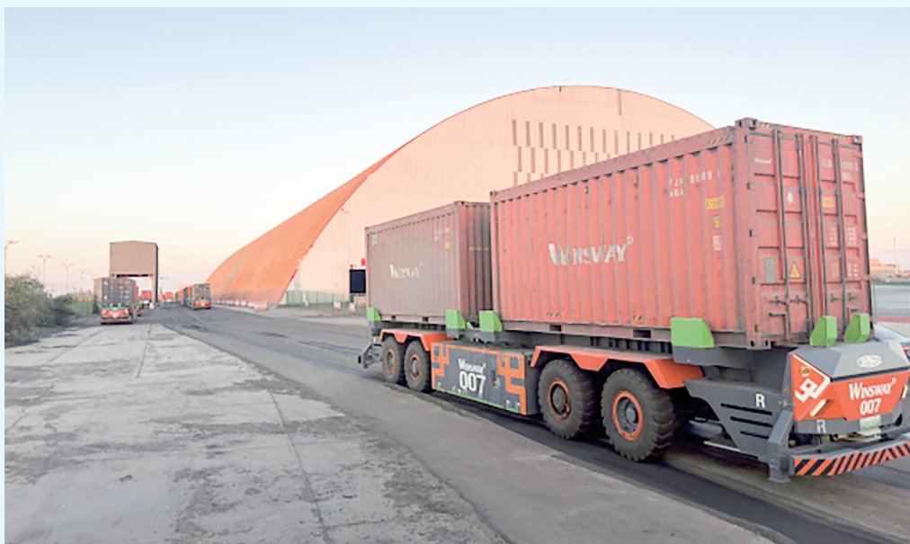
甘其毛都口岸运行AGV无人驾驶车。新华社记者李云平摄
