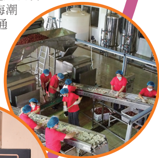
▲新鲜荔枝脱壳去核榨汁生产线。
