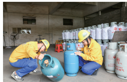
工人们正在分检企业自有产权钢瓶,将符合标准要求的钢瓶贴上标注有气瓶提供单位、产权单位、钢瓶生产日期三个信息的标签纸,做好登记后移交上车。
