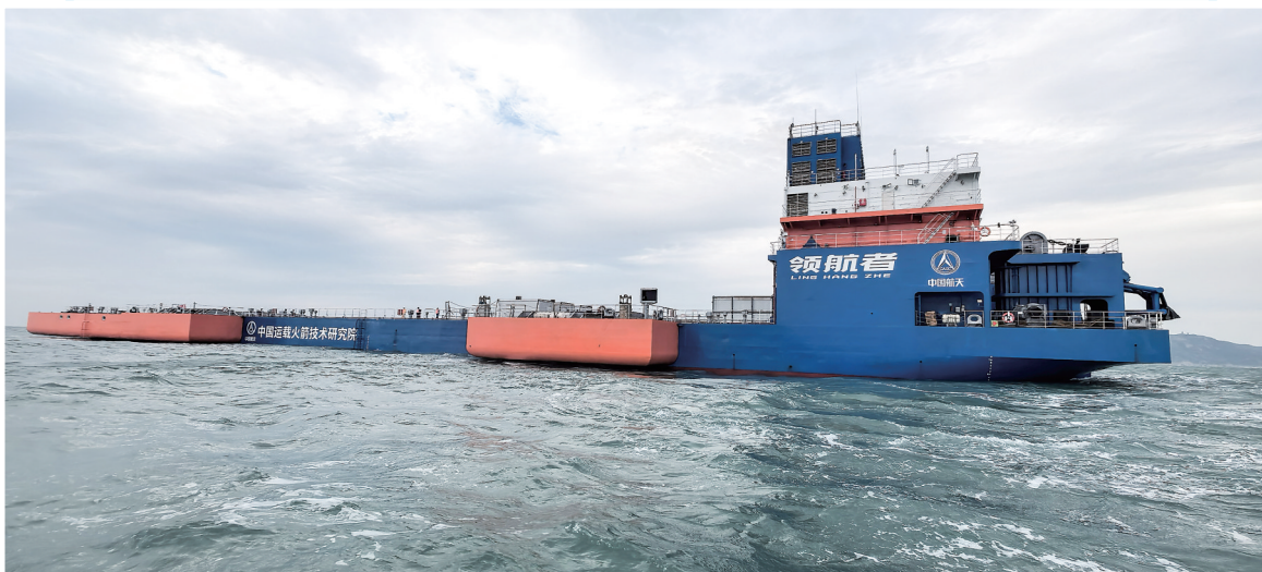
“领航者”火箭网系回收海上平台。(中国航天科技集团一院供图)
