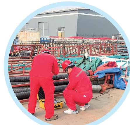
安徽中科昊音智能科技有限公司工作人员正在对油田软管管道进行声纹AI检测。受访者供图
