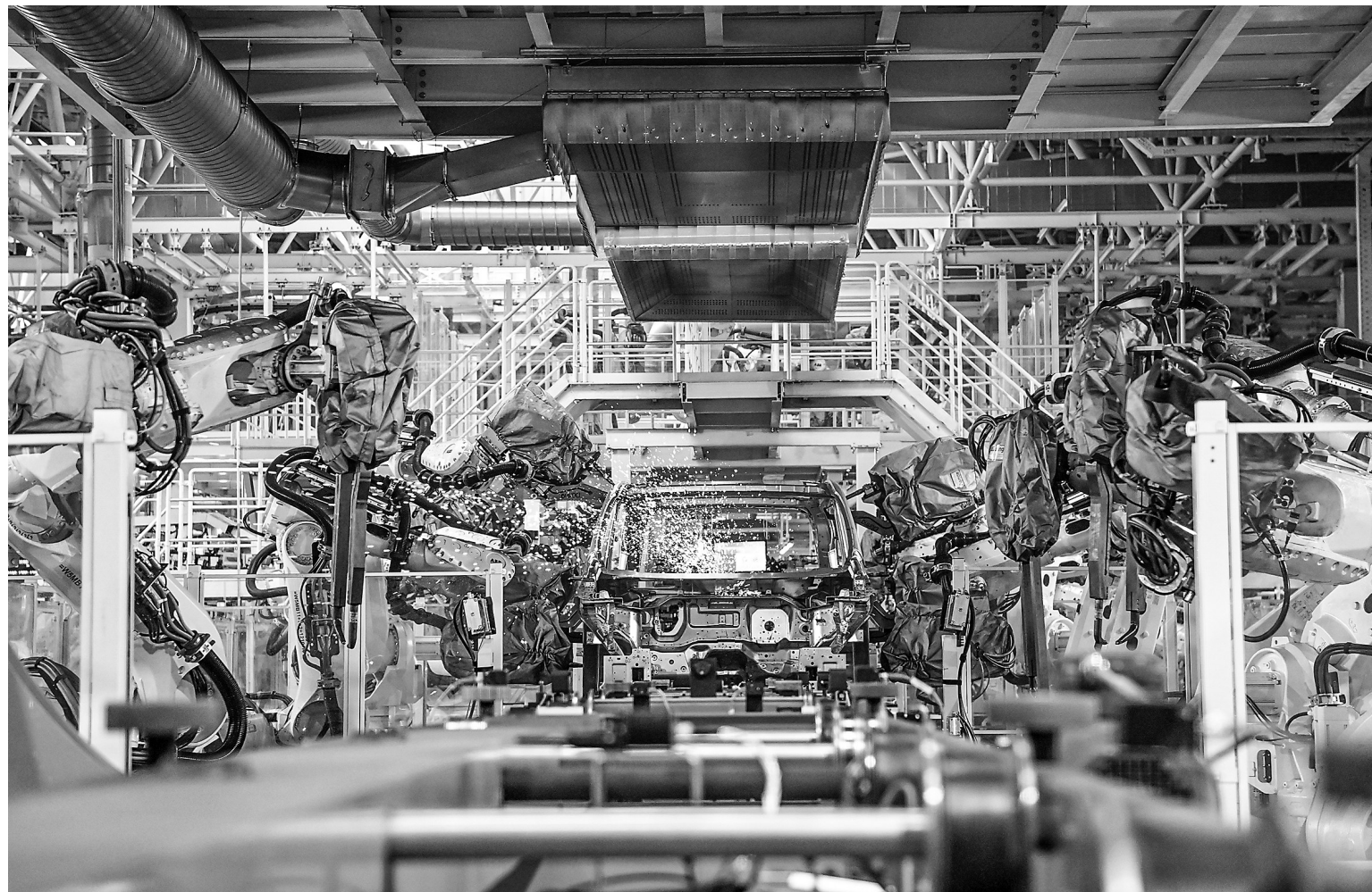
10月17日,在吉林长春中国第一汽车集团有限公司红旗繁荣工厂焊装车间内,焊接机器人在生产线上焊接车身。新华社记者 麟麟 摄
