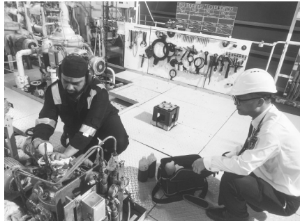
船员配合执法人员在主机滤器旁开展燃油取样。 通讯员 李泽果 摄
