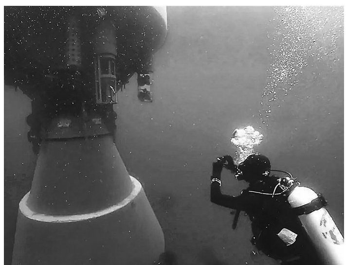
李剑平团队研发的水下暗场成像仪悬在浮标上。受访者供图
